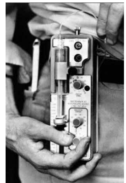
シリンジタイプの注射器を装置に 取り付ける形のインスリンポンプ
